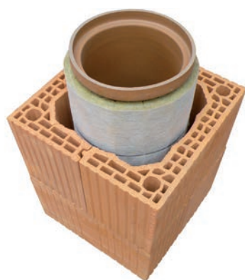
Дымоходная система HELUZ MULTI для твердого топлива с тепловой изоляцией. Система MULTI для газообразного топлива поставляется без изоляции.
