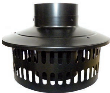
Дымоходная система HELUZ ГАЗ оканчивается конусом, который отводит продукты сгорания и одновременно через боковые отверстия приводит воздух к потребителю.
