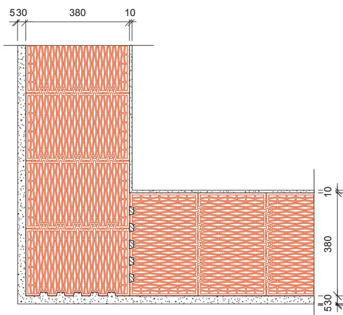
HELUZ FAMILY 38 с внешней термоизоляционной штукатуркой толщиной 30мм (λ= 0,10 Вт/мК) + 5 мм отделочной штукатурки с внутренней VC штукатуркой толщиной 10 мм.
