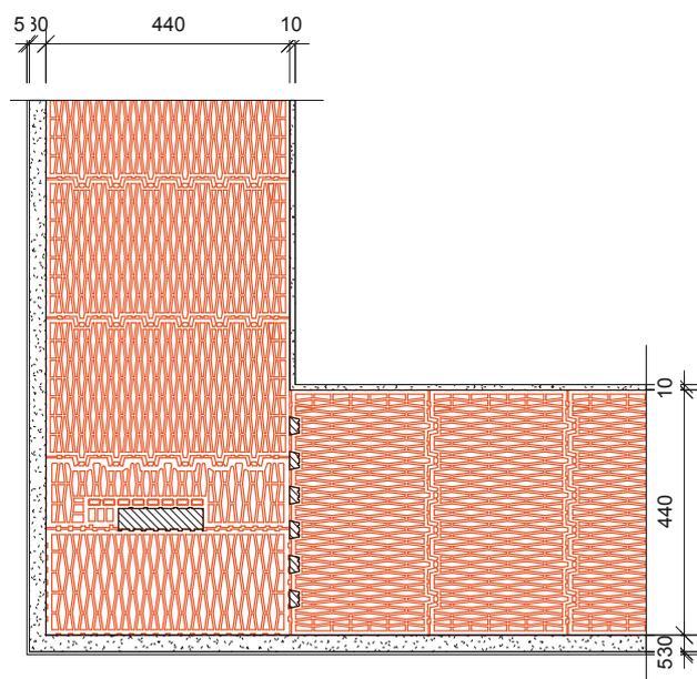
HELUZ FAMILY 44 с внешней термоизоляционной штукатуркой толщиной 30мм (λ= 0,10 Вт/мК) + 5 мм отделочной штукатурки с внутренней VC штукатуркой толщиной 10 мм.
